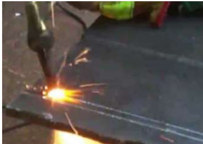
Figura 14. Manufactura de corte de acetileno.
