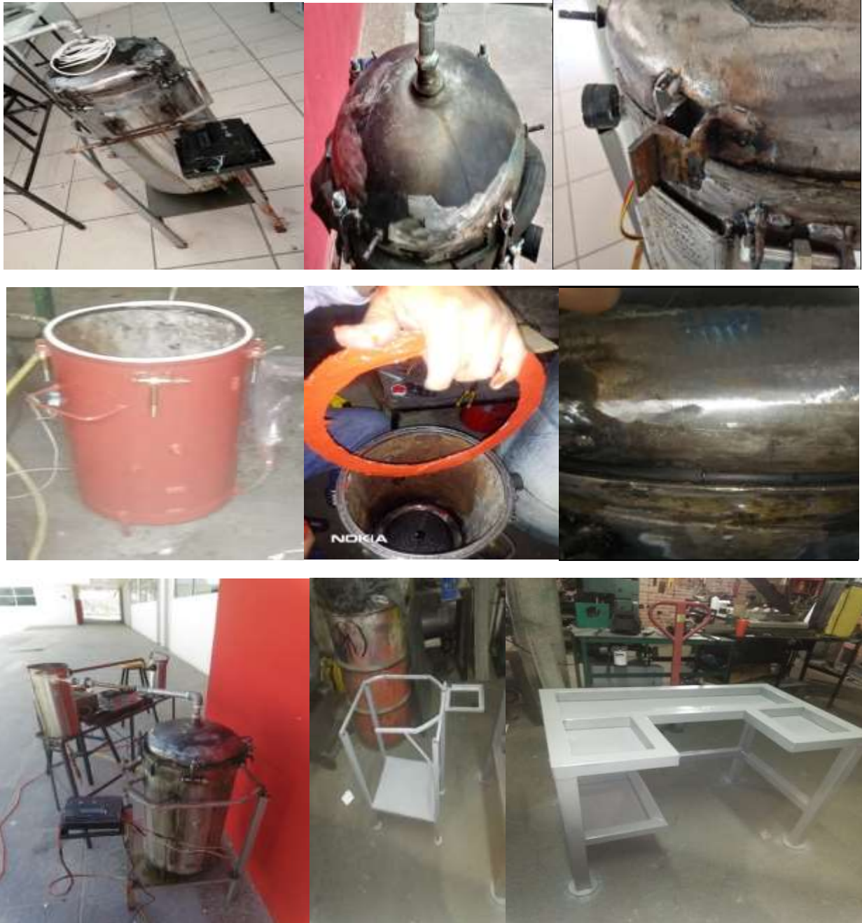
Figura 31. Manufactura de reingeniería del reactor pirolítico.
