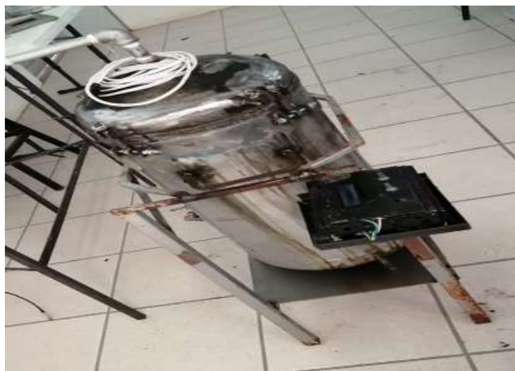
Figura 20. Descripción del reactor pirolítico (antes de manufactura)
