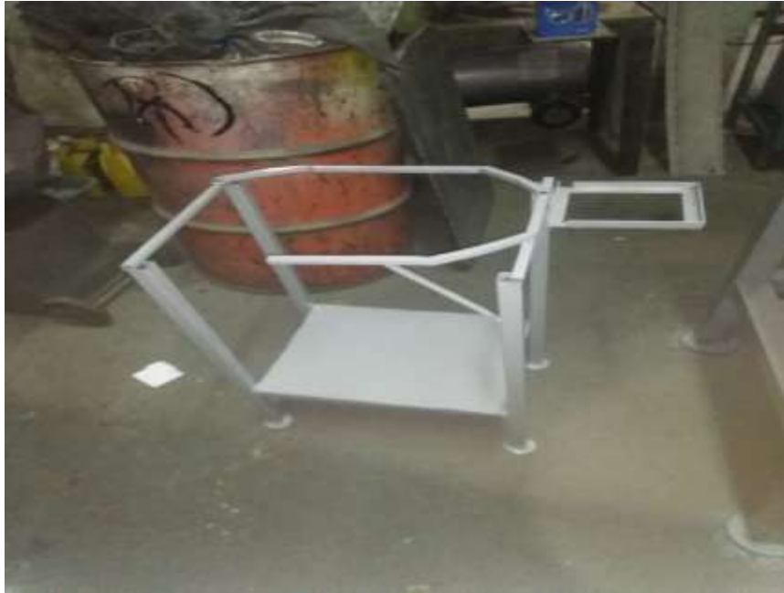
Figura 26. Reingeniería de base de tanque pirolítico.
