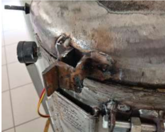
Figura 21. Ménsulas de clampeo de sujeción por tornillos antes de reingeniería de manufactura.
