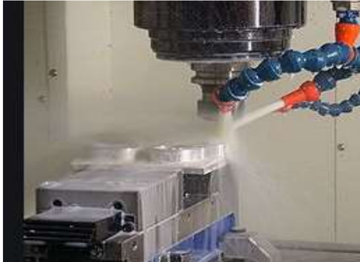
Figura 29. Maquinado de fresado de placa de sistema de enfriamiento Peltier.
